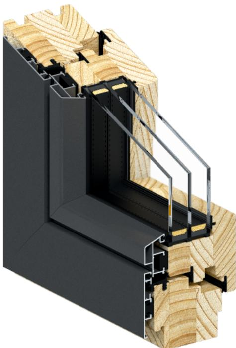
Linear è un sistema in cui il bordo esterno del telaio e dell'anta è modellato con uno spigolo decisamente smussato. La combinazione di un profilo in legno di alta qualità e del resistente rivestimento in ALU di Linear consente di ottenere una finestra quasi priva di manutenzione. Le caratteristiche principali del rivestimento in ALU di Linear sono: lunga durata, elevata resistenza agli agenti esterni e stabilità dimensionale.
